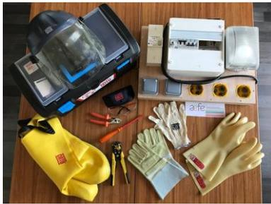
Des travaux pratiques sont réalisés sur une platine pédagogique composée de divers équipements et outils, que le stagiaire utilise muni des équipements de protection individuels (EPI) adaptés.
